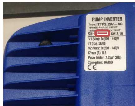
Figura 1: marcatura del numero seriale di costruzione
