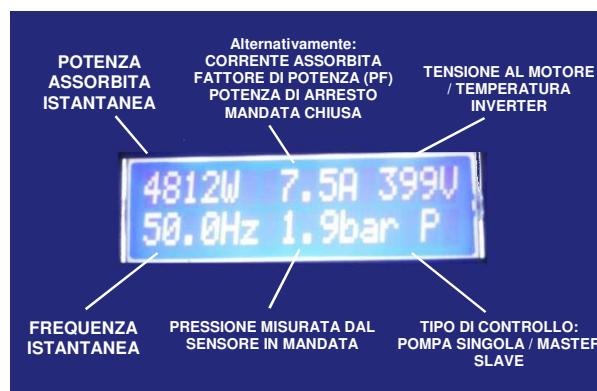
Figura 17: Presentazione dei dati sul display
